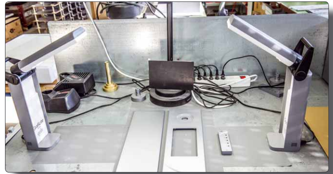
Ganz wichtiger Arbeitsplatz: Hier werden die Eloxalprozesse so abgeglichen, dass alle Blechteile immer die gleiche Farbe haben
